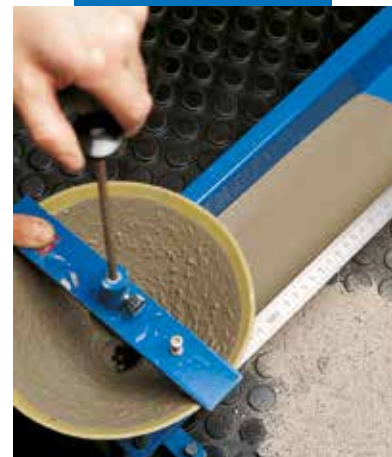
Испытание расширения в канавке согласно норме UNI 8997/89
